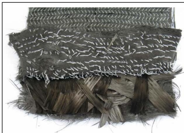
Abbildung 3: Mehrlagiger Aufbau Krempelvlies-Carbonfaserroving-Krempelvlies.
